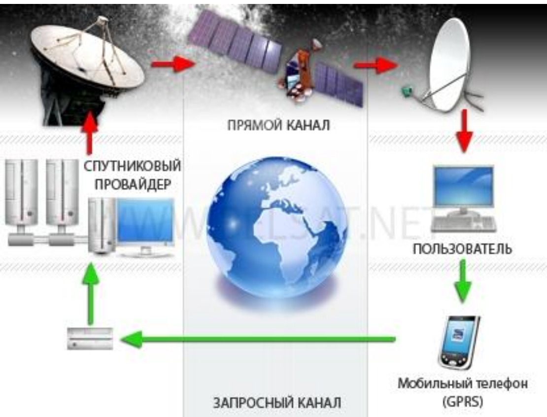
Схема организации асимметричного спутникового канала связи
