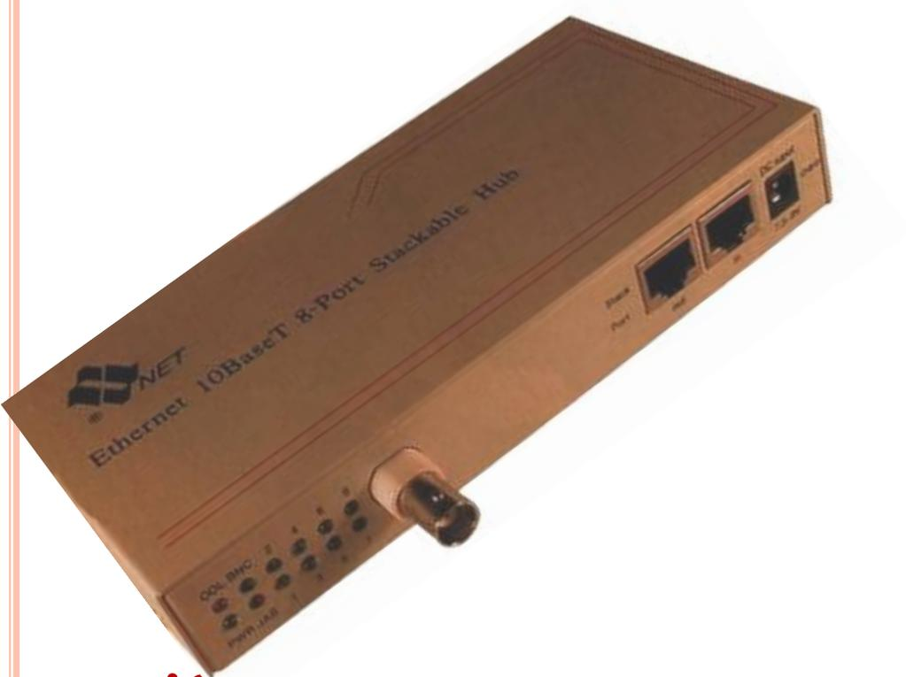
**Концентраторы** служат для соединения компьютеров в сети.
