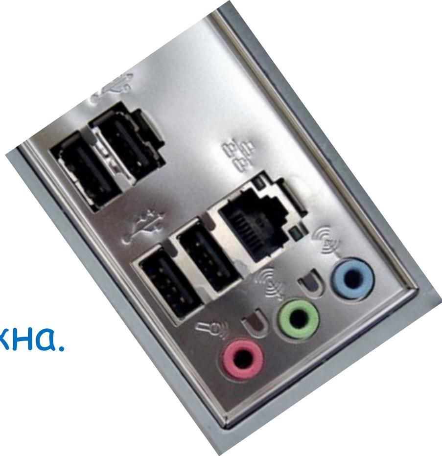
Тогда гнездо для сетевого кабеля расположено на задней стенке системного блока.
