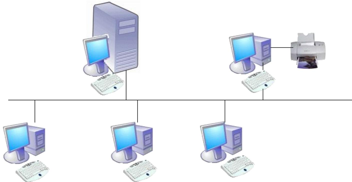
Кабель проходит от одного компьютера к другому, соединяя компьютеры и периферийные устройства
