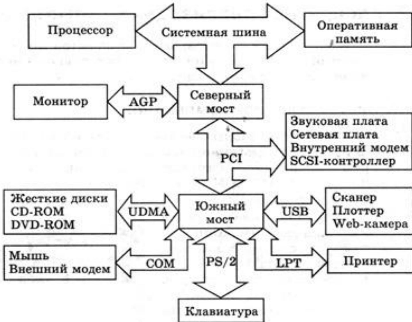
Схема магистрально-модульного принципа построения ПК
