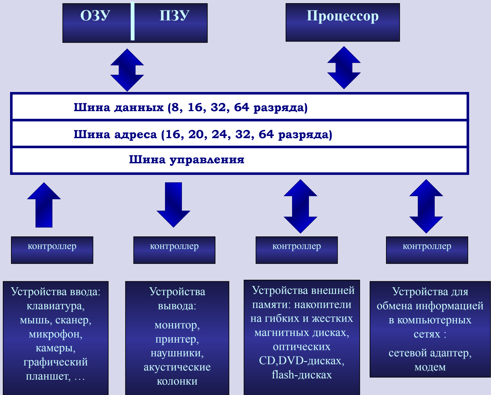
Рис. Функциональная схема компьютера, построенного по магистрально-модульному принципу.
