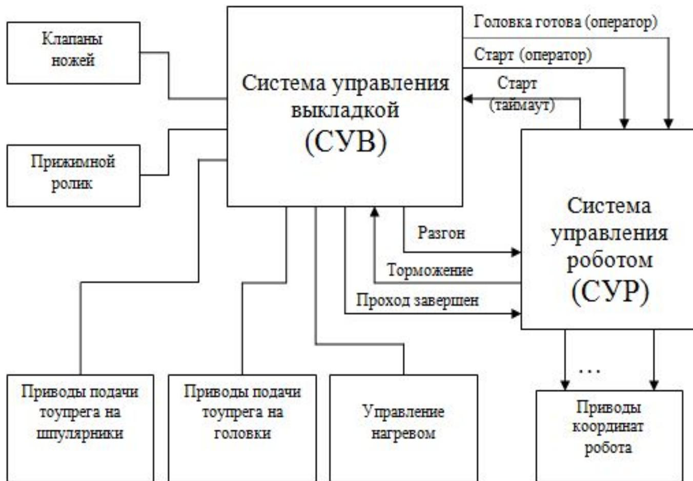
*Схема связей выкладочной машины*
