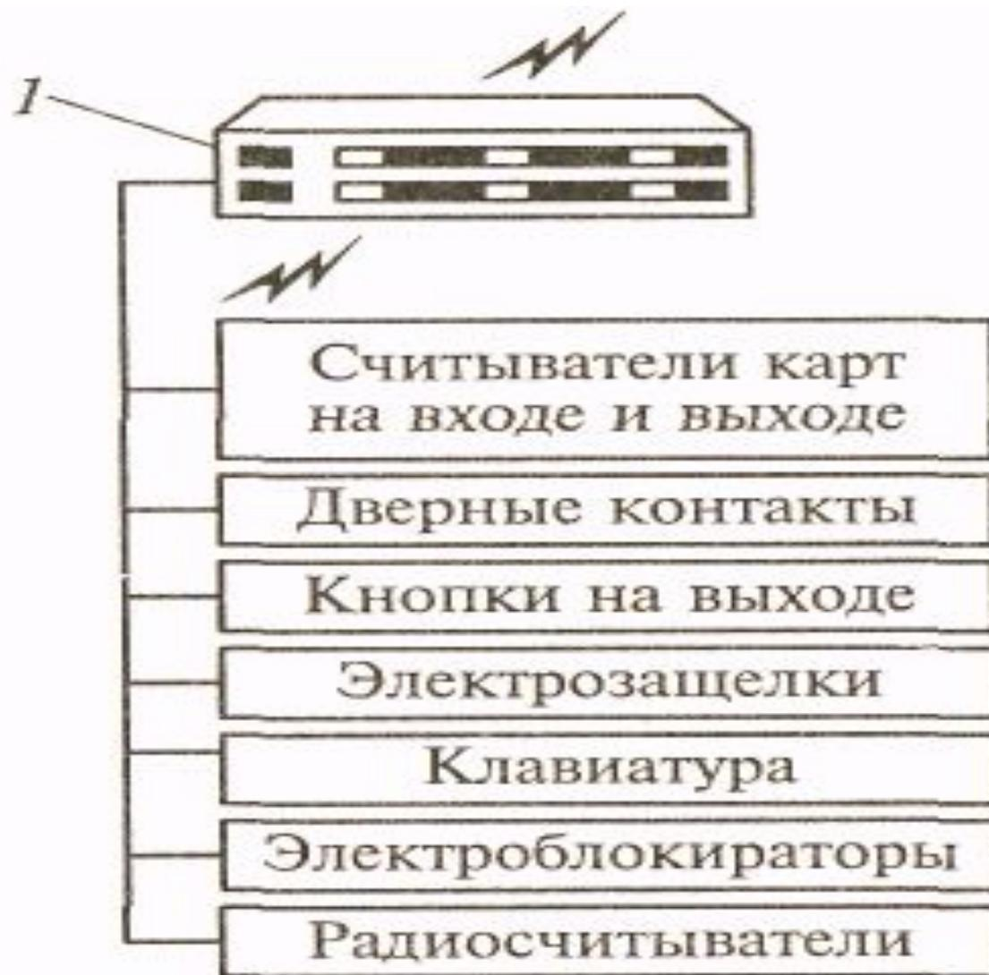
Рис. 5.9. Структурная схема управления доступом:
