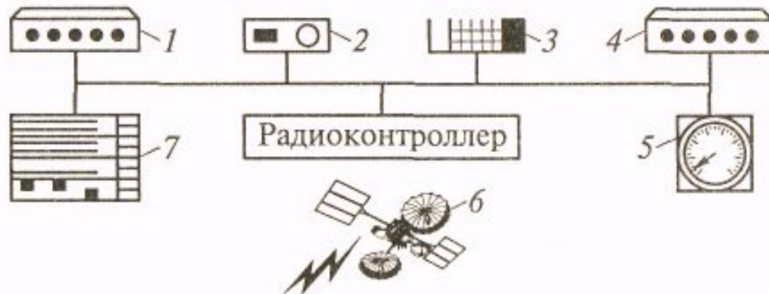
Рис. 5.5. Функциональная схема аварийной, пожарной и охранной сигнализации системы оповещения:
