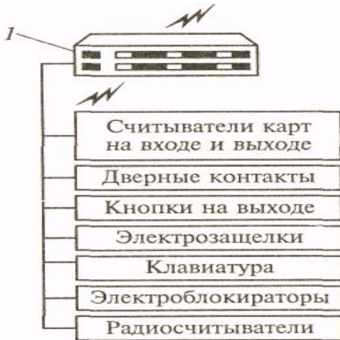
Рис. 5.9. Структурная схема управления доступом: I — контроллер
