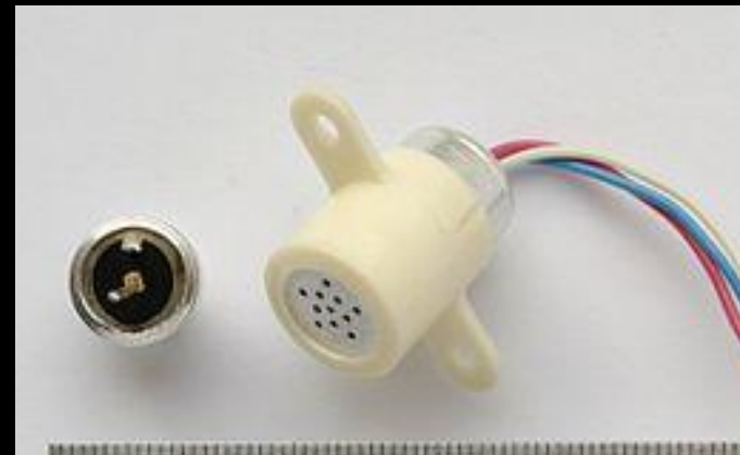
Слева электретный капсюль (конденсатор) микрофона МКЭ-3, справа — весь микрофон
