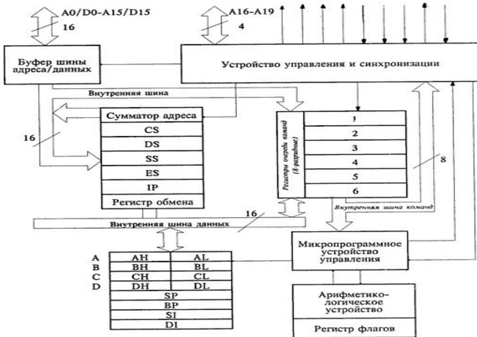
Рис.2. Внутренняя структура микропроцессора 8086.
