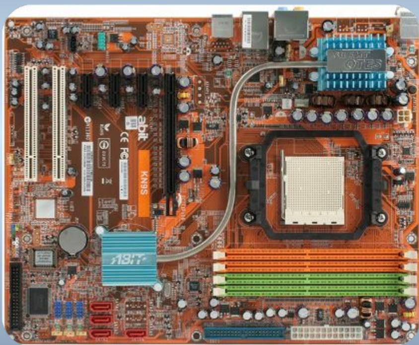
В ДАННОМ СЛУЧАЕ ЧИПСЕТ СНАБЖЕН СИСТЕМОЙ ОХЛАЖДЕНИЯ
