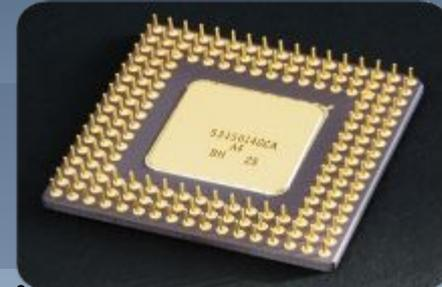
**Центральный процессор** (CPU, от англ. Central Processing Unit) — это основной рабочий компонент компьютера, который выполняет арифметические и логические операции, заданные программой, управляет вычислительным процессом и координирует работу всех устройств компьютера.
