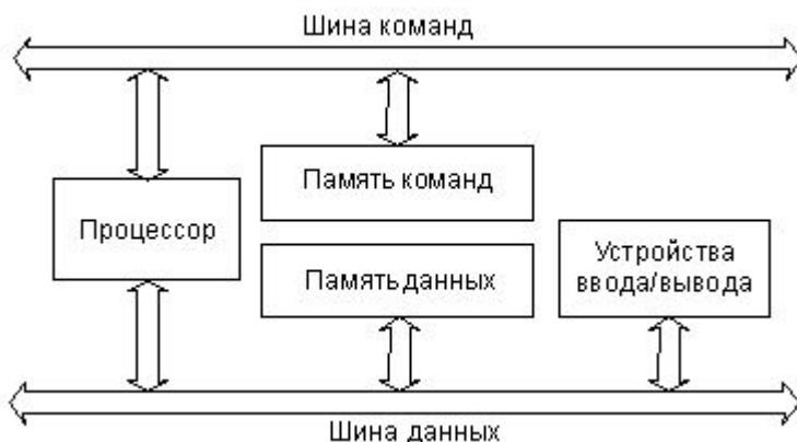
Рис. 1.5. Архитектура с раздельными шинами данных и команд
