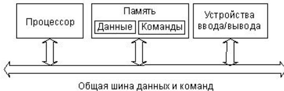
Рис. 1.4. Архитектура с общей шиной данных и команд.
