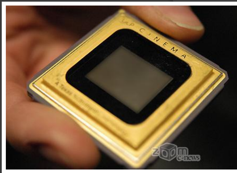
На этом DMD-чипе, основе DLP-технологии расположено 2 073 600 микрозеркалец
