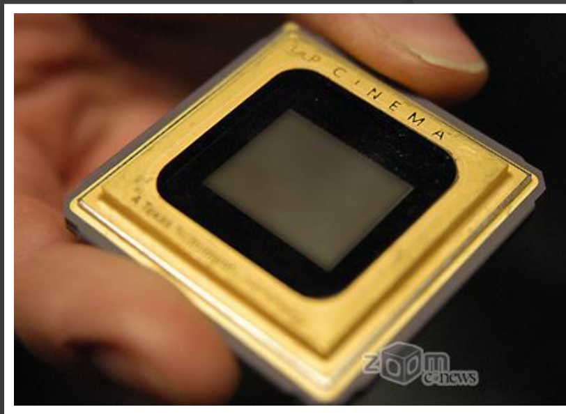
На этом DMD-чипе, основе DLP-технологии расположено 2 073 600 микрозеркалец
