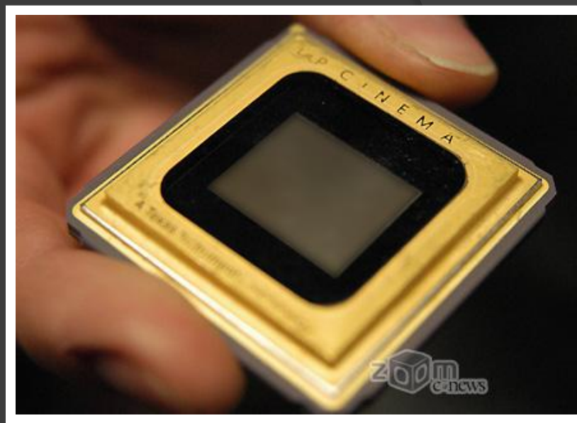
На этом DMD-чипе, основе DLP-технологии расположено 2 073 600 микрозеркалец
