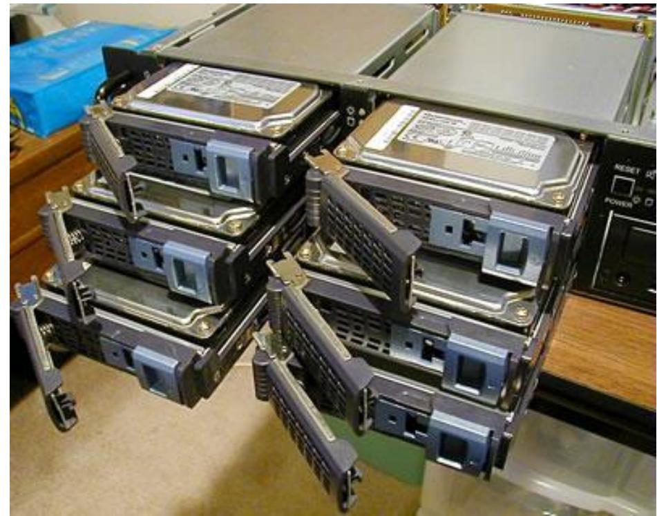
**RAID 0 (striping – «членение»)** – дисковый массив из двух жёстких дисков с отсутствием резервирования. Информация разбивается на блоки данных ( $A_i$ ) и записывается на оба диска одновременно.
