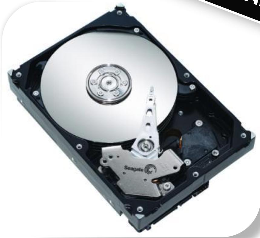
**Накопитель на жёстких магнитных дисках (Hard Disk Drive, HDD),** жёсткий диск, винчестер — энергонезависимое устройство хранения информации, основанное на принципе магнитной записи. Является основным накопителем данных в большинстве компьютеров.
