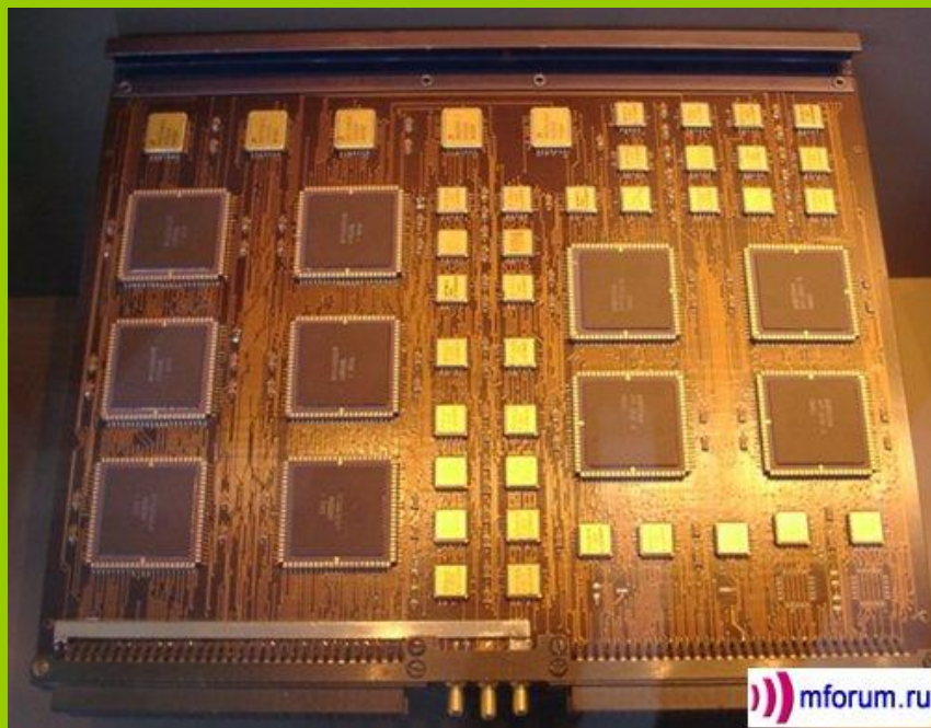
Плата, построенная на БИС
