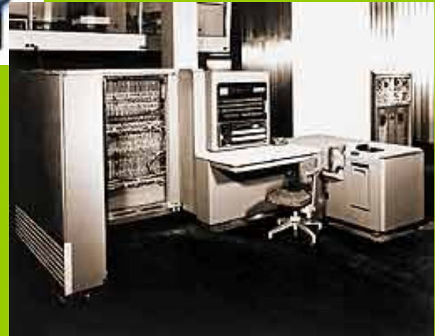
IBM 701 – первая машина, построенная на электронно-вакуумных лампах
