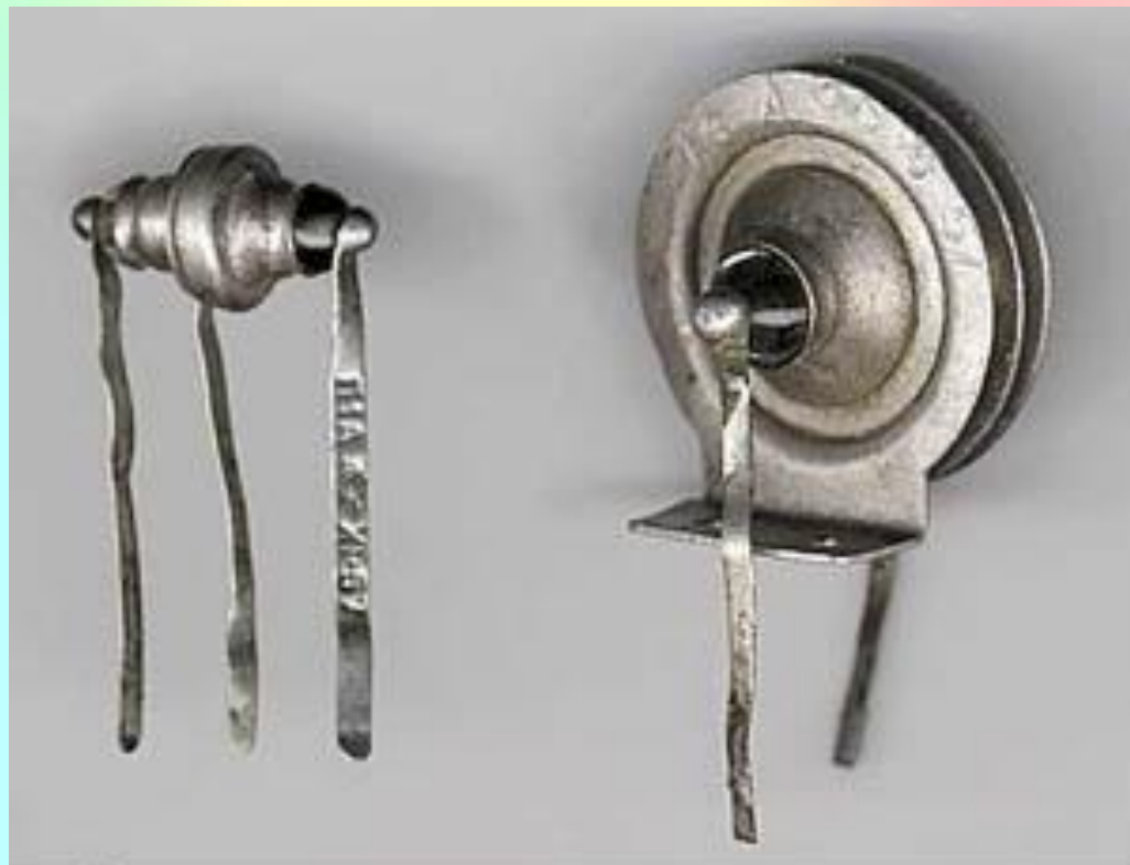
Первые отечественные транзисторы. П1А и П3А (с радиатором). 1957 год.
