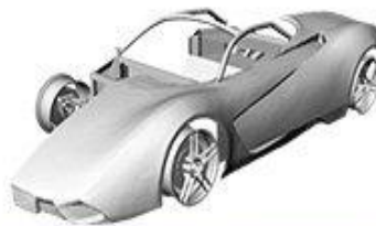
Совмещение полигональной модели внешних панелей с CAD-моделью рамы и шасси
