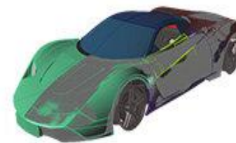
Построение CAD-поверхностей по сетке (показано совмещение с STL-моделью)
