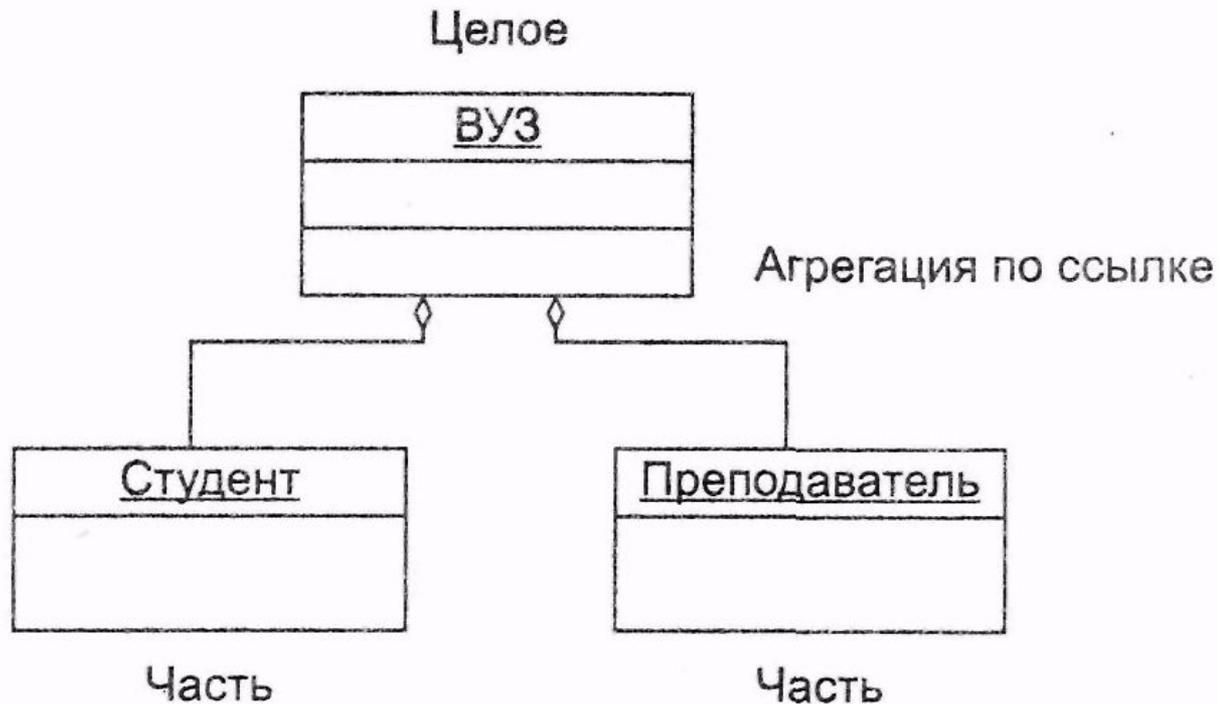
Рис. 9.8. Нефизическое включение частей в агрегат
