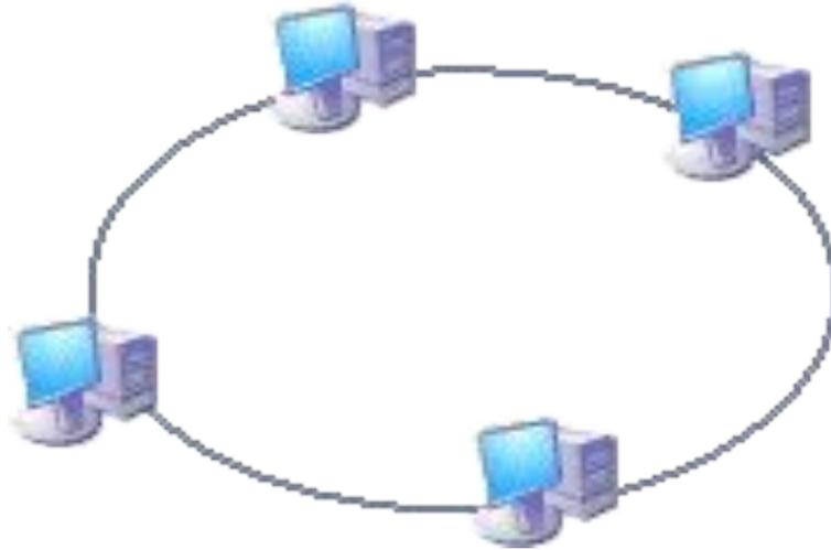
базовая топология компьютерной сети, в которой рабочие станции подключены последовательно друг к другу, образуя замкнутую сеть.
