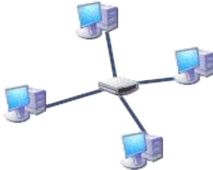
базовая топология компьютерной сети, в которой все компьютеры сети присоединены к центральному узлу (обычно сетевой концентратор).
