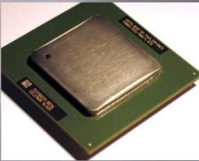
Центральный процессор (ЦП, также центральное процессорное устройство — ЦПУ; англ. *central processing unit, CPU*, дословно — *центральное обрабатывающее устройство*) — электронный блок либо интегральная схема (микропроцессор), исполняющая машинные инструкции (код программы), главная часть аппаратного обеспечения компьютера или программируемого логического контроллера. Иногда называют *микропроцессором* или просто *процессором*.
