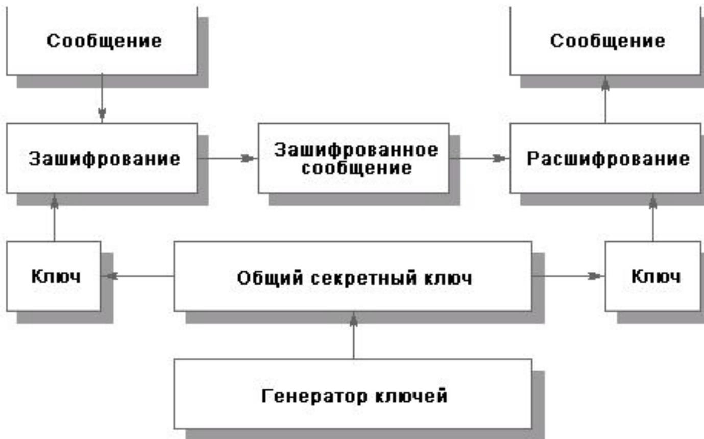
Рис. 11.1. Использование симметричного метода шифрования.
