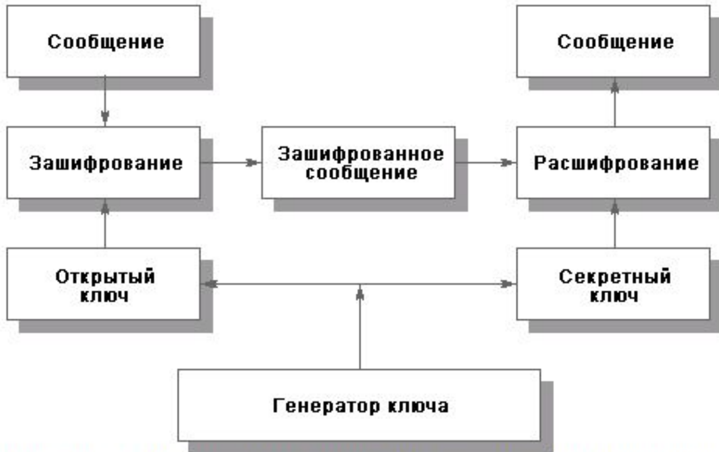
Рис. 11.2. Использование асимметричного метода шифрования.
