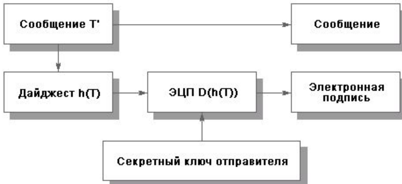
Рис. 11.5. Выработка электронной цифровой подписи.
