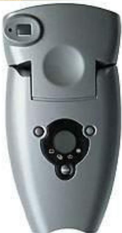
Принцип работы цифровой камеры аналогичен принципу работы фотоаппарата: оптическая система проецирует уменьшенное изображение на матрицу из светочувствительных элементов ПЗС (CCD) или КМОП (CMOS). Далее оцифрованное изображение сжимается в формат JPEG, FlashPix или аналогичный им и затем записывается в память камеры, емкостью которой и определяется количество снимков. Для передачи в ПК записанного в памяти камеры изображения могут использоваться различные носители и интерфейсы.
