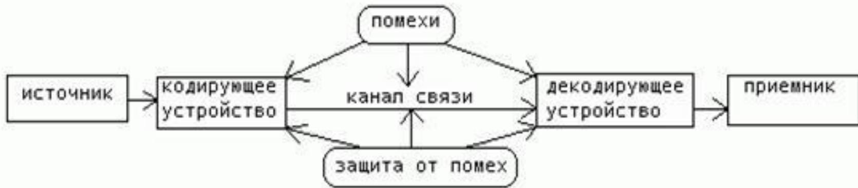
Рис. 3. Передача информации при наличии помех
