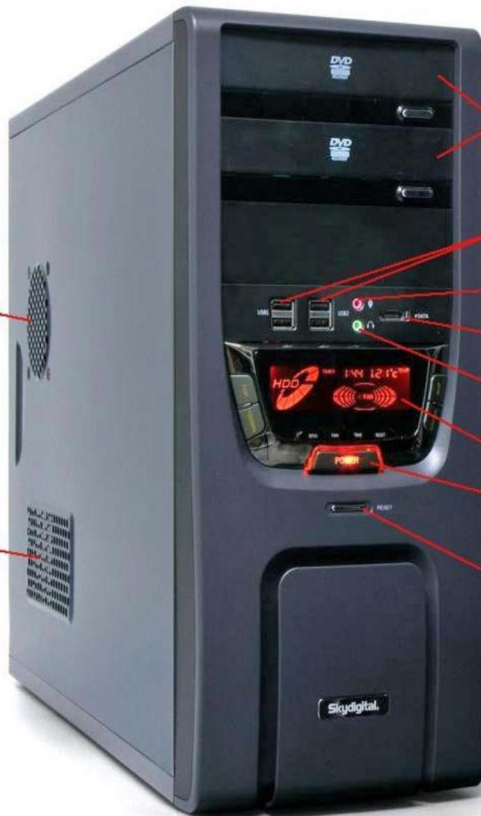
Отверстие предназначено для дополнительного притока воздуха, который непосредственно попадает на кулер центрального процессора (CPU)
