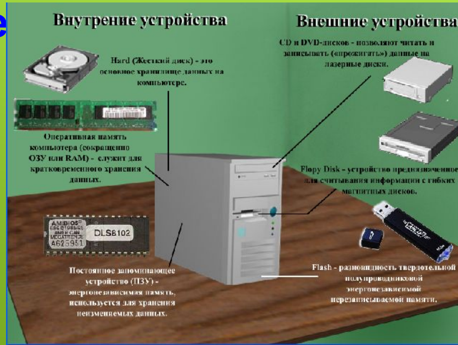
Рис. 1.5. Основные устройства, входящие в состав компьютера
