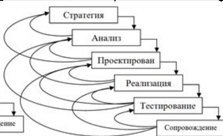
Поэтапная модель с промежуточным контролем
