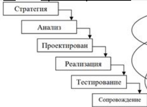
Каскадная модель жизненного цикла АС
