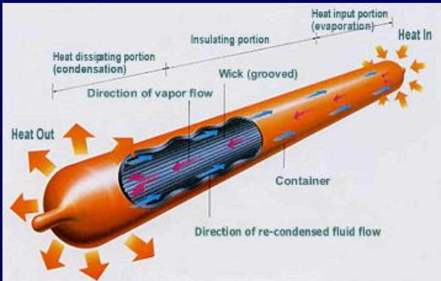
Тепловые трубы (англ. heat pipe) — элемент системы охлаждения, принцип работы которого основан на том, что в закрытых трубах из теплопроводящего металла (например, меди) находится легкоиспаряющиеся жидкости. Перенос тепла происходит за счёт того, что жидкость испаряется на горячем конце трубы и конденсируется на холодном, а затем снова перетекает на горячий конец. Такая система обладает большой теплопроводностью.
