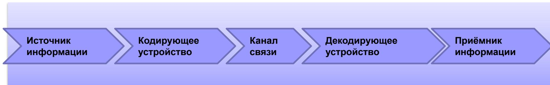
Преобразование информации, идущей от источника, в форму, пригодную для её передачи по каналу связи, называется кодированием.
