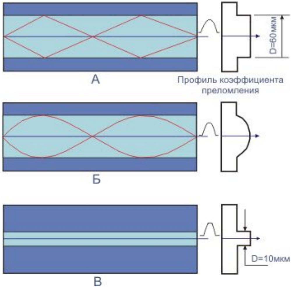
Разновидности оптических волокон, отличающиеся зависимостью коэффициента преломления от радиуса
