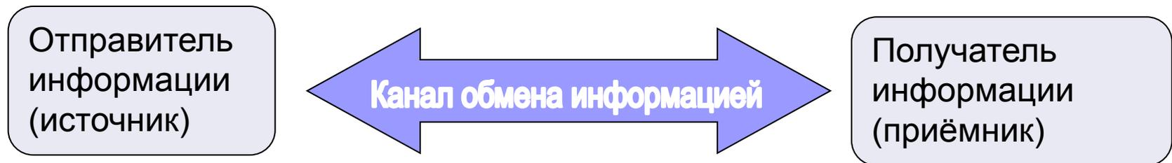
**Скорость передачи информации** (пропускная способность канала) - количество информации в битах в секунду (бит/с) и в производных единицах (Кбит/с, Мбит/с, Гбит/с):
