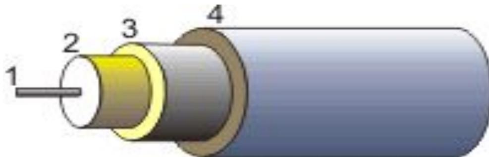
**1** - центральный проводник; **2** - изолятор; **3** - проводник-экран; внешний изолятор
