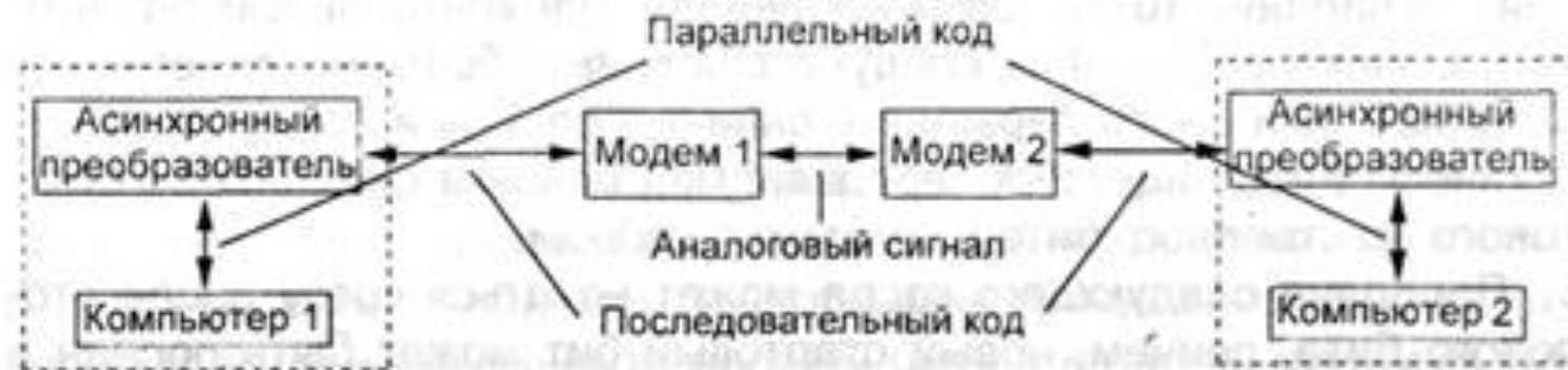
Рис. 5.3. Компьютерная линия связи с применением модемов
