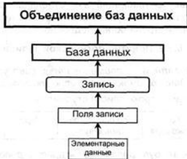
Рис. 6.4. Иллюстрация многоуровневой иерархической структуры данных
