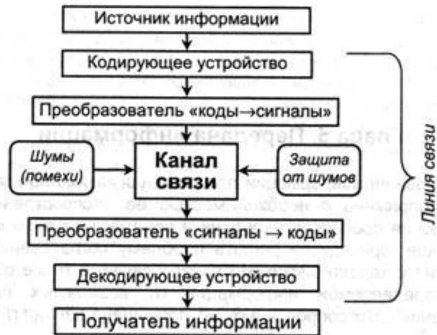
Рис. 5.1. Общая схема передачи информации
