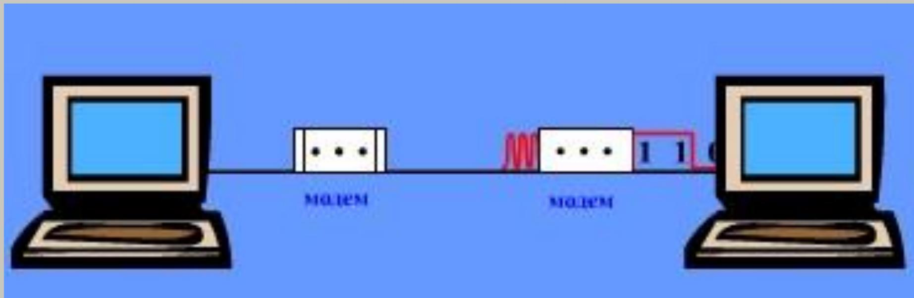
МОДЕМ – МОдулятор – ДЕМОдулятор – устройство, обеспечивающее кодирование и декодирование сигнала.
