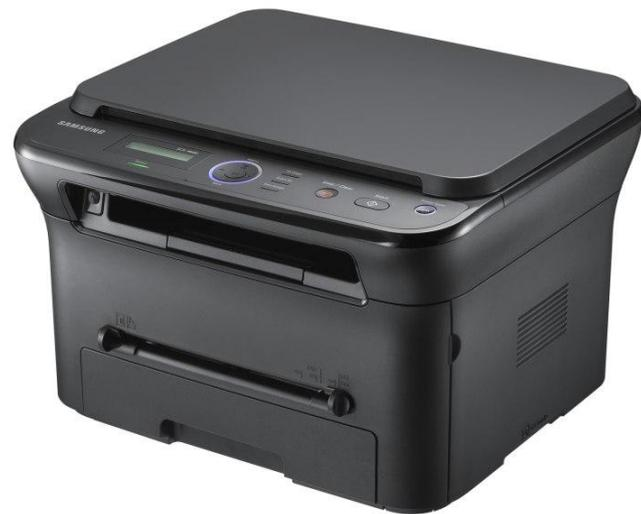
**МФУ** – это принтер, объединённый со сканером, в результате чего получается устройство для печати, сканирования и копирования в одном корпусе. Добавление платы факс-модема и интерфейса телефонной линии превращает такое устройство в офисный МФУ с функцией обработки факсов. Современные МФУ, как правило, универсальны - обладают сразу несколькими интерфейсами, слотами под флэш-карты, встроенной памятью для хранения данных и т.п.
