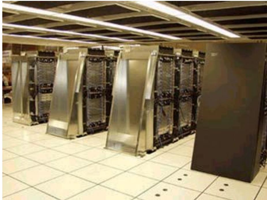
Достроенный в 2005 г. в США самый мощный в мире суперкомпьютер Blue Gene/L компании IBM удвоил принадлежавший ему же рекорд производительности. Теперь официально заявленная производительность этой вычислительной системы составляет 280,6 терафлопов или 280,6 триллионов операций в секунду.
