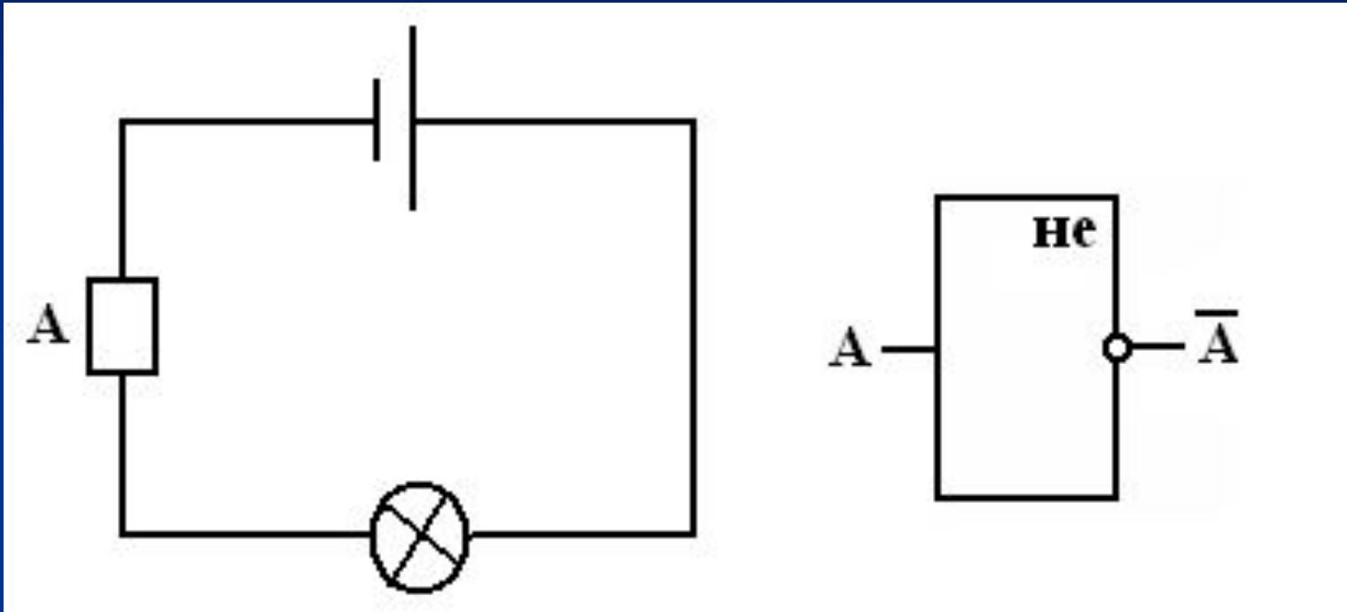
Физически каждый логический элемент представляет собой электронную схему, в которой на вход подаются некоторые сигналы, кодирующие 0 либо 1, а с выхода снимается также сигнал, соответствующий 0 или 1 в зависимости от типа логического элемента.
