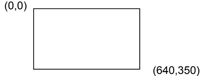
Линия, которая в заданном графическом режиме проведет диагональ на экране.
