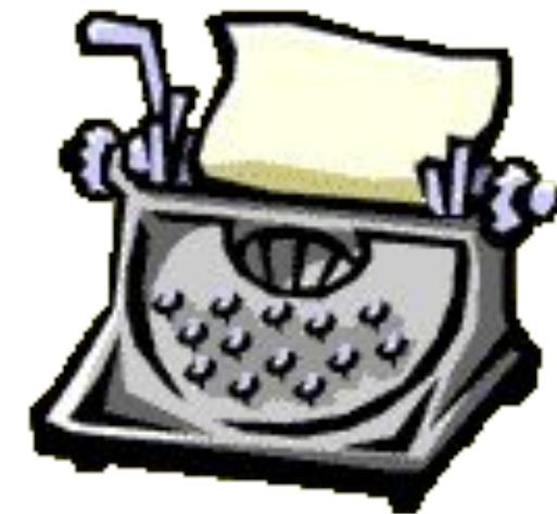
У них были такие же буквы, закрепленные на рычагах, при механическом воздействии на рычаг буквы, ударяли по бумаге через копировальную бумагу или специальную красящую ленту и оставляли на бумаге отпечаток буквы.
