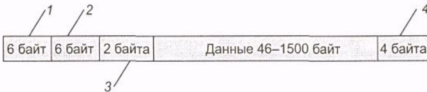
Рис. 2.11. Формат кадра Ethernet II:
