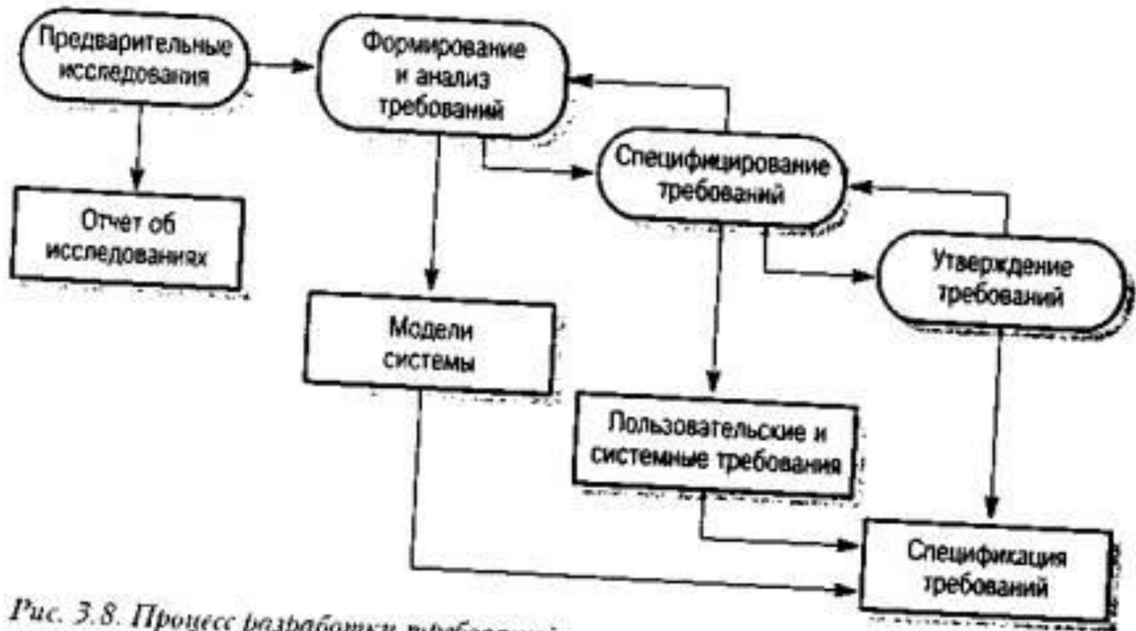
Рис. 3.8. Процесс разработки требований
