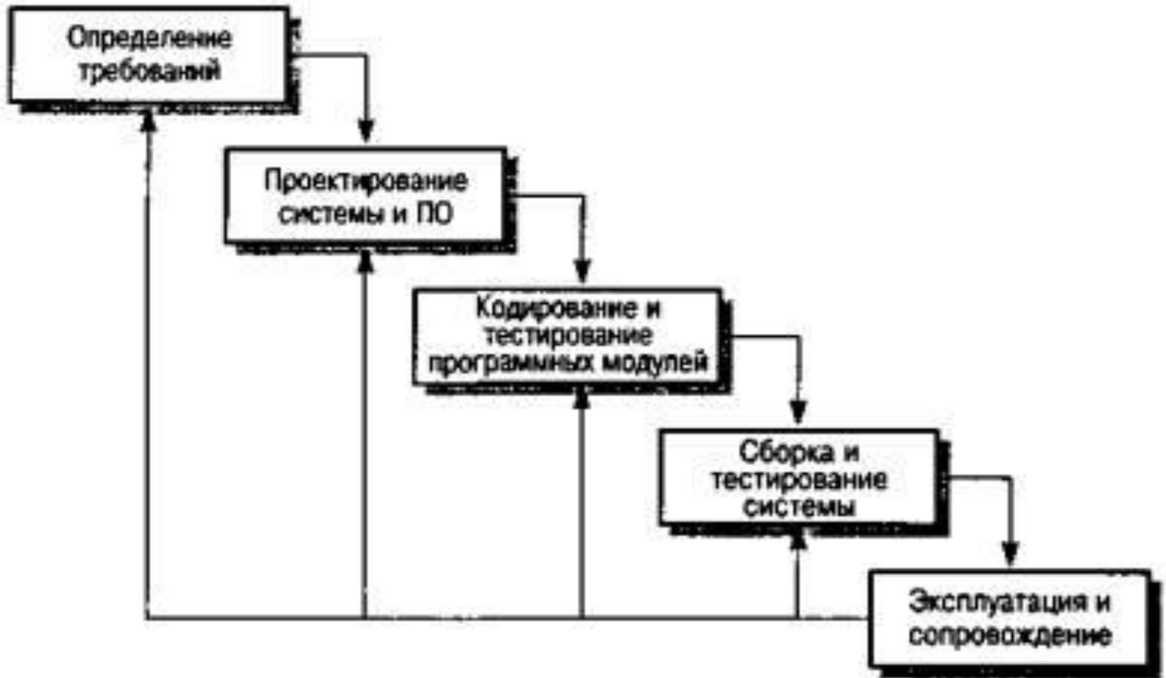
Рис. 3.1. Жизненный цикл программного обеспечения
