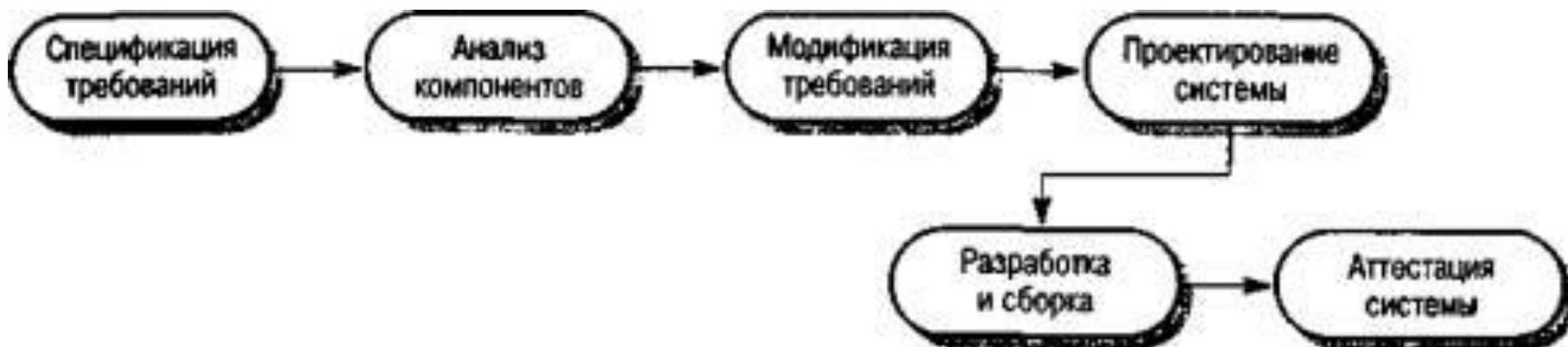
*Разработка ПО с повторным использованием ранее созданных компонентов*
