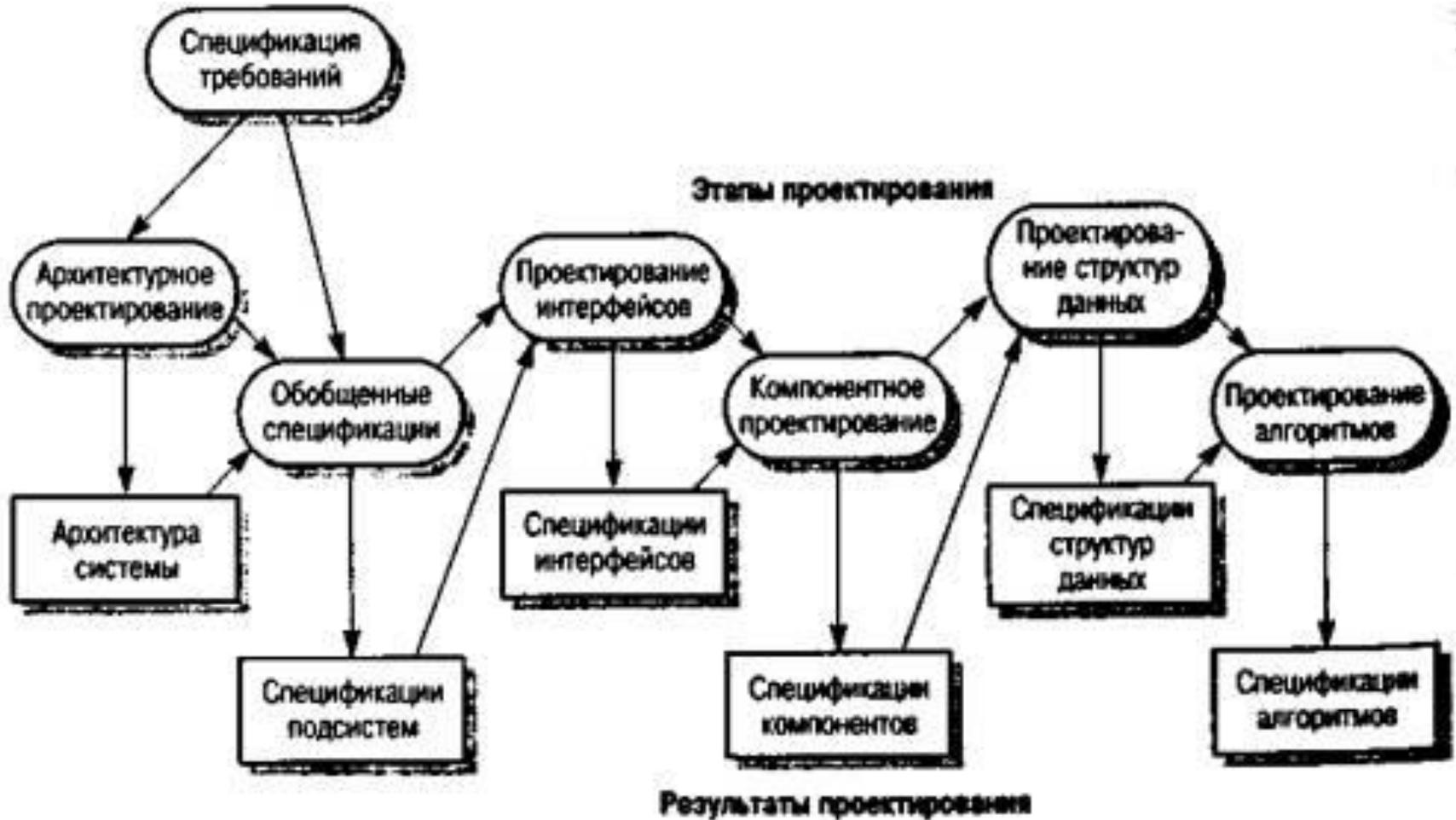
Рис. 3.9. Обобщенная схема процесса проектирования
