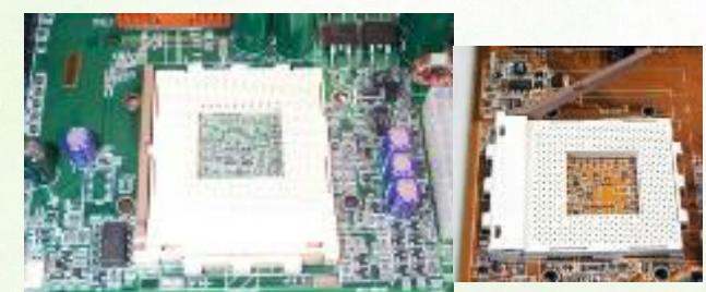
Процессор устанавливается в специальный разъем на системной плате. Для различных типов процессоров требуются различные типы разъемов.
