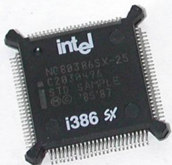
Intel 80386 1985 275 000 транзисторов виртуальная память
