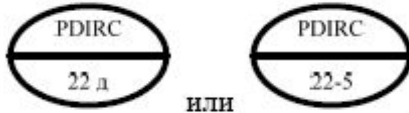
то оно должно быть прочитано так: “Прибор, относящийся к 22-й функциональной группе, стоящий 5-м в этой группе, расположен на щите управления и предназначен для регистрации R и автоматического регулирования С перепада давления PD с одновременной визуализацией (показаниями) Г”
