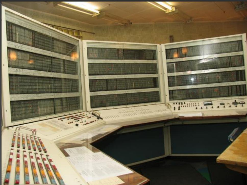
БЭСМ-1 - первая ЭВМ из серии больших электронных счетных машин.
