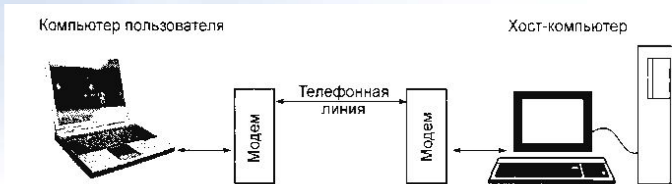
Рис. 1.2. Организация связи между пользователем и узлом сети по телефонной линии
