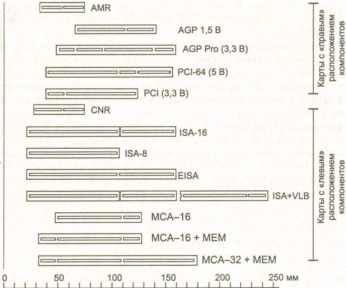
Вид и положение слотов шин расширения
