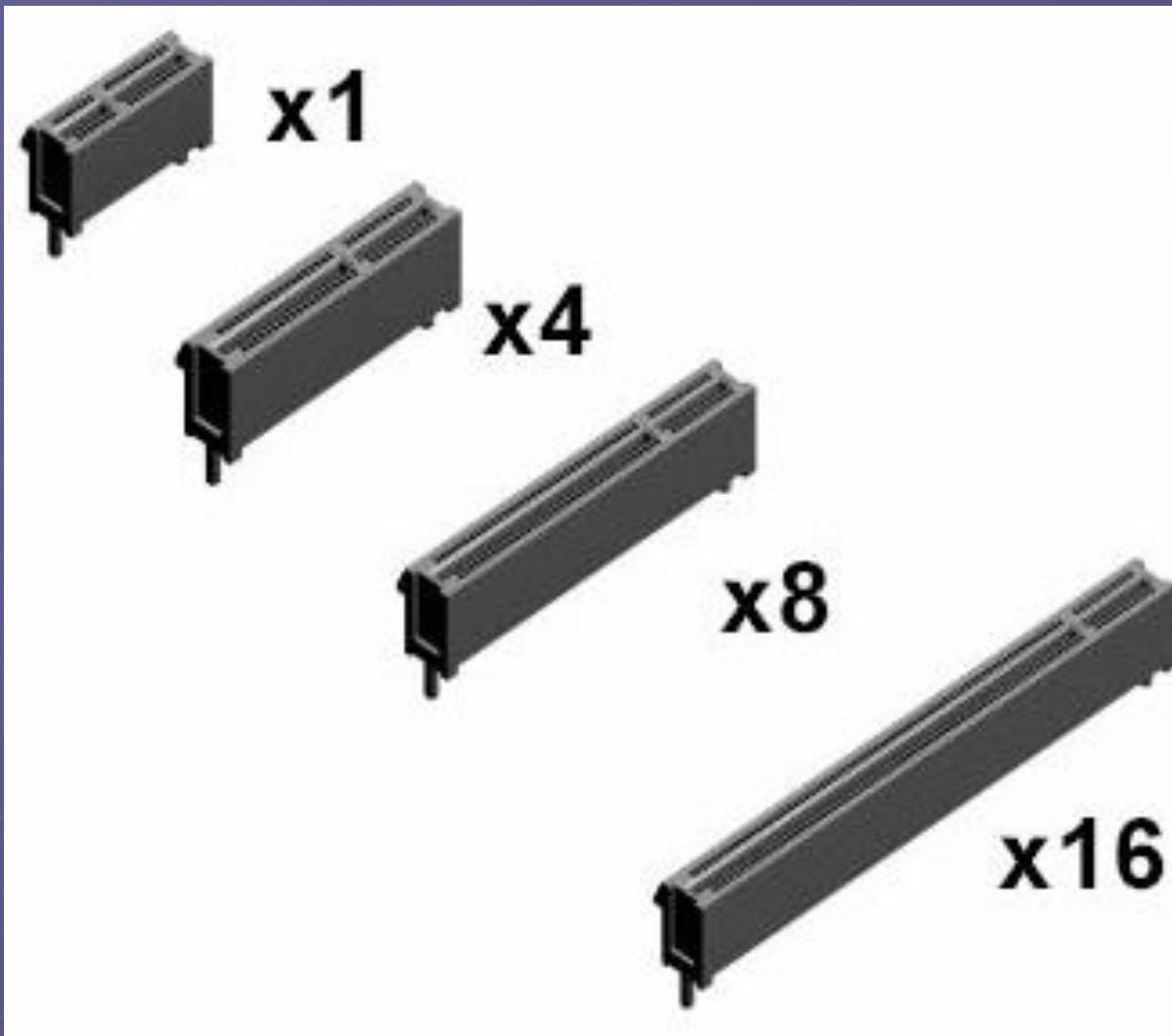
Версии PCI Express будут внедряться в зависимости от ставящихся перед интерфейсом задач и типом устройства. Например, серверы, где востребована максимальная пропускная способность, будут оборудованы максимальным количеством слотов PCI Express с максимальными показателями. В то же время, для нужд ноутбуков в большинстве случаев будет достаточно архитектуры PCI Express x1. Для настольных ПК и рабочих станций понадобится комбинация из различных вариантов реализации шины.
