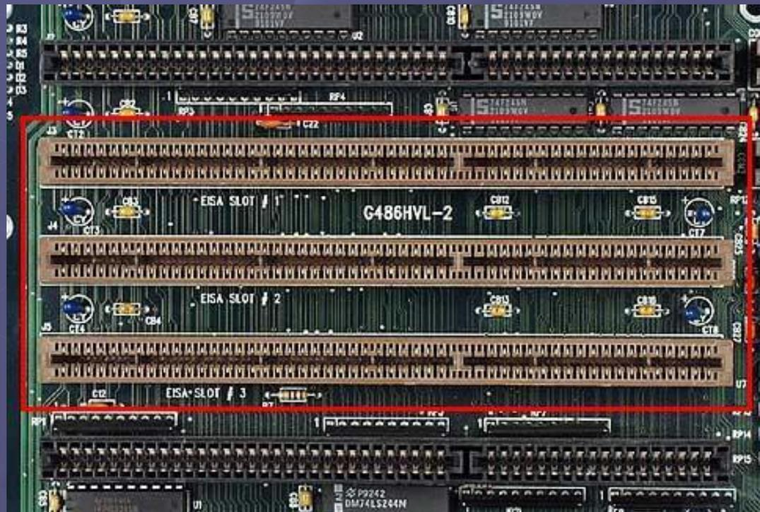
Шина ISA-8 может предоставить до 6 линий запросов прерываний, ISA-16 —11. Часть из них могут «отобрать» устройства системной платы или шина PCI. Шина ISA-8 позволяет использовать до трех 8-битных каналов DMA. На 16-битной шине доступны еще три 16-битных и один 8-битный канал. Все перечисленные ресурсы шины должны быть бесконфликтно распределены. Бесконфликтность подразумевает выполнение перечисленных ниже условий.
