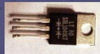
диодная сборка LT (10А)
