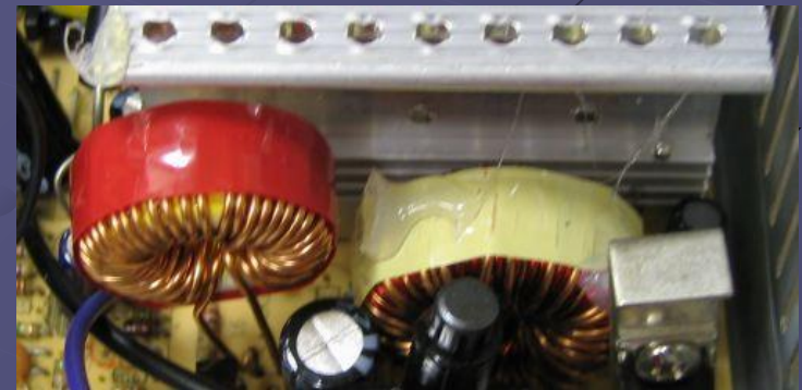
Две капли термоклей, символизирующие жесткое крепление дросселей.
