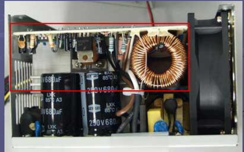
Плата активного PFC (Thermaltake PurePower HPC-420-302DF)
