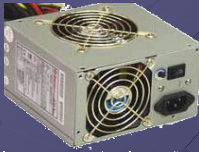
Блоки питания с 120x120 и 80x80+90x90 вентиляторами (тип 3 и тип 4)
