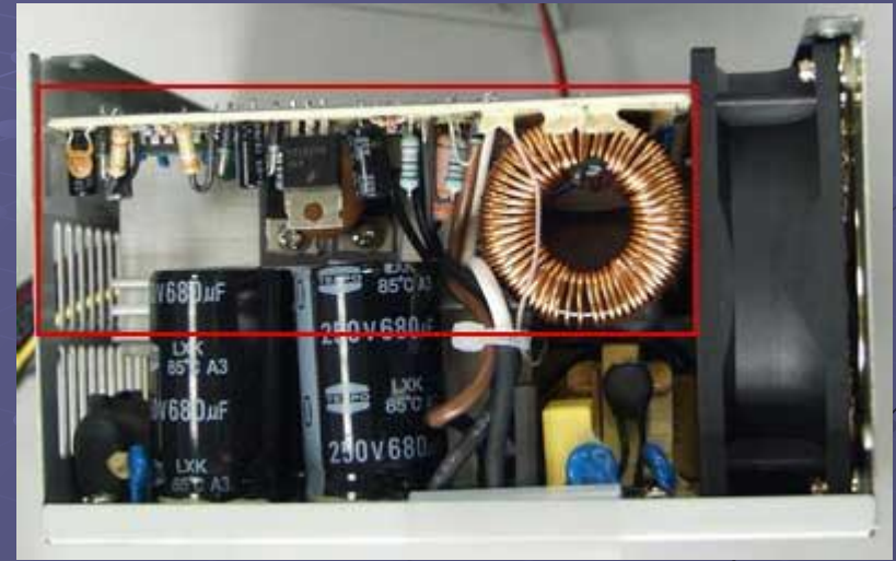
Плата активного PFC (Thermaltake PurePower HPC-420-302DF)
