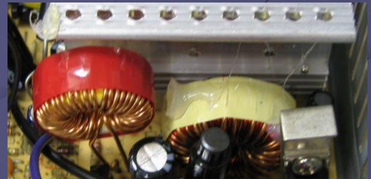
Две капли термоклей, символизирующие жесткое крепление дросселей.
