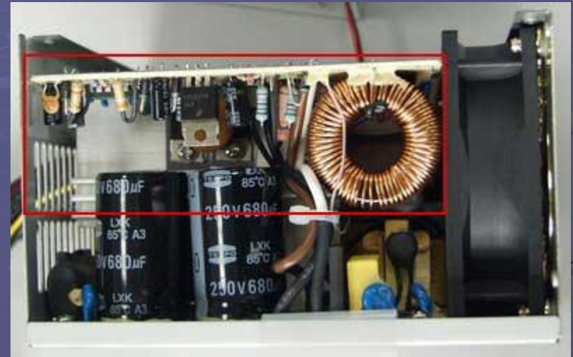
Плата активного PFC (Thermaltake PurePower HPC-420-302DF)
