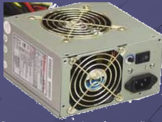
Блоки питания с 120x120 и 80x80+90x90 вентиляторами (тип 3 и тип 4)
