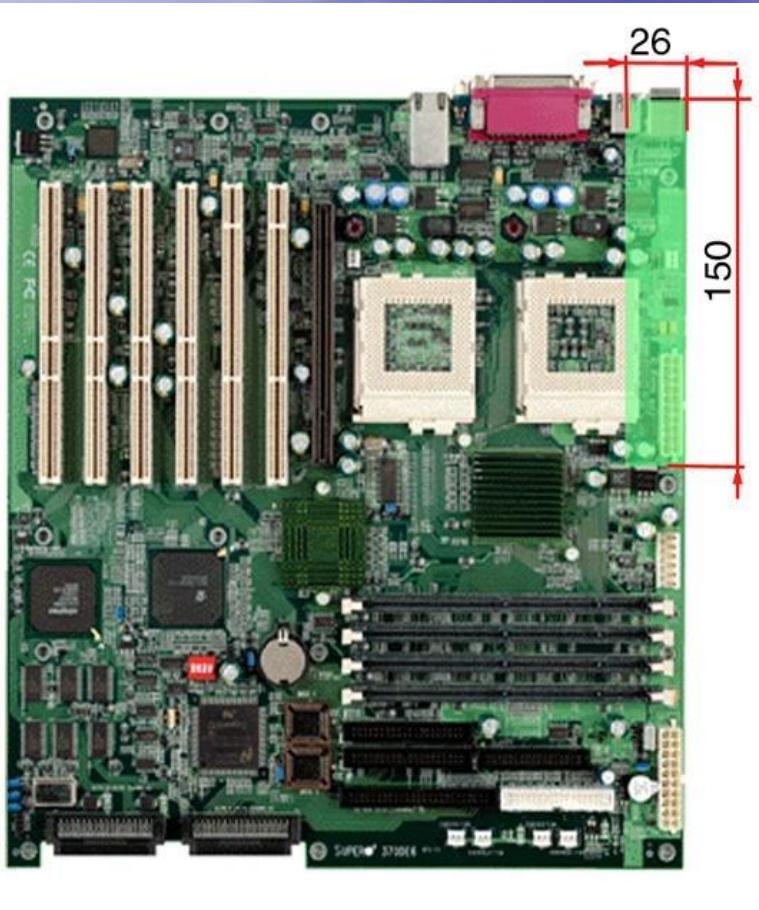
На материнской плате можно встретить всевозможные переключатели, задающие режимы работы компонентам материнской платы, а также разъемы для подсоединения к системе различных устройств. Такие разъемы называются *слотами расширения* системы. Слоты позволяют расширять возможности ПК путем введения в его состав новых периферийных устройств.
