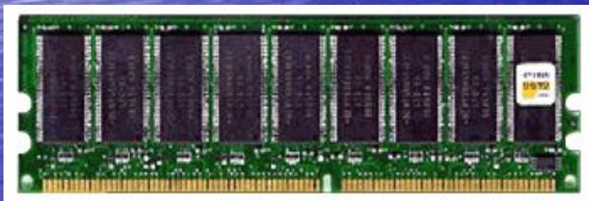
**Оперативная память (ОЗУ)** - это основная память компьютера, предназначенная для хранения текущих данных и выполняемых программ, а также копий отдельных модулей операционной системы. Большинство программ в процессе выполнения резервируют часть оперативной памяти для хранения своих данных. К данным, хранящимся в оперативной памяти, ЦП может обращаться непосредственно, используя хост-шину. После отключения питания компьютера все содержимое ОЗУ стирается.
