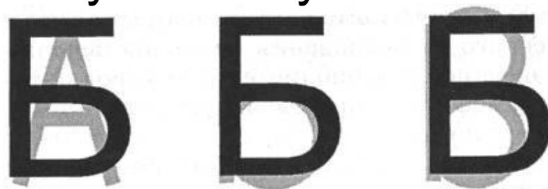
Например, распознаваемый символ "Б" накладывается на векторные шаблоны символов (А, Б, В и т. д.)
