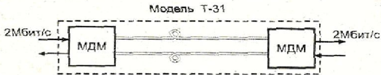
Рисунок 6.2 - Функциональная схема оборудования Т-31 (РОТЕК)
