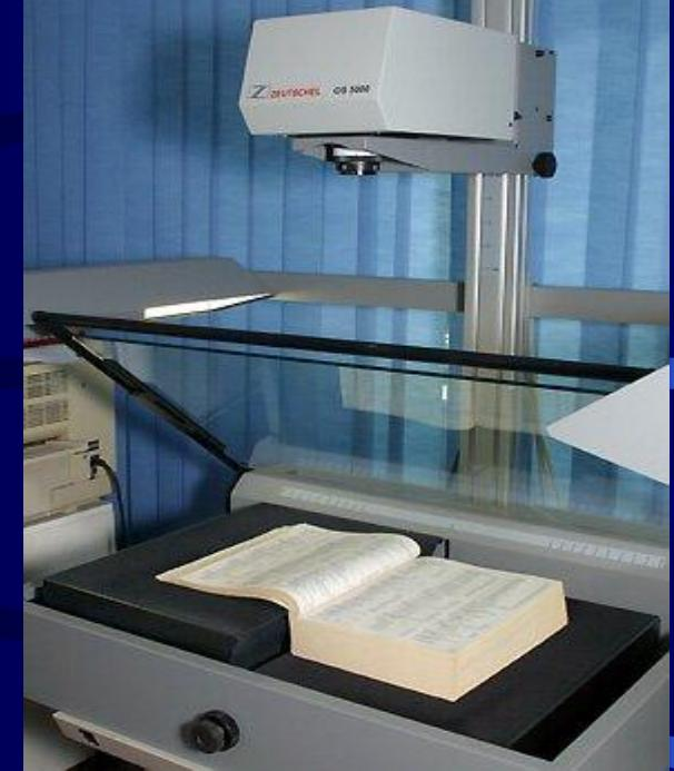
Проекционные сканеры не получили широкого распространения, так как предназначены сугубо для профессионального использования. Приборы эти незаменимы для дизайнеров и архитекторов, так как позволяют обойтись без предварительного фотографирования.
